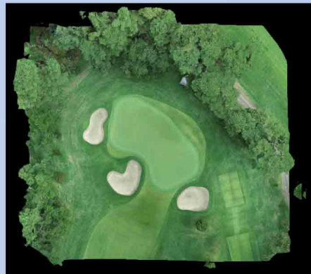
グリーン上を撮影し、数百枚の写真を統合し3Dモデルにしました。(3D)
